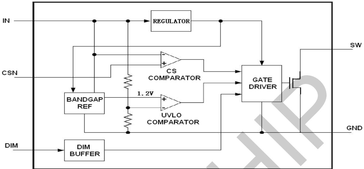
PT4115 和电感 (L)、电流采样电阻 (RS) 形成一个自振荡的连续电感电流模式的降压型恒流 LED 控制器。VIN 上电时，电感 (L) 和电流采样电阻 (RS) 的初始电流为零，LED 输出电流也为零。这时候，CS 比较器的输出为高，内部功率开关导通，SW 的电位为低。电流通过电感 (L)、电流采样电阻 (RS)、LED 和内部功率开关从 VIN 流到地，电流上升的斜率由 VIN、电感 (L) 和 LED 压降决定，在 RS 上产生一个压差 V<sub>CSN</sub>。当 (V<sub>IN</sub> - V<sub>CSN</sub>) > 115 mV 时，CS 比较器的输出变低，内部功率开关关断，电流以另一种斜率流过电感 (L)、电流采样电阻 (RS)、LED 和肖特基二极管 (D)。当 (V<sub>IN</sub> - V<sub>CSN</sub>) < 85 mV 时，功率开关重新打开，这样使得在 LED 上的平均电流为：
